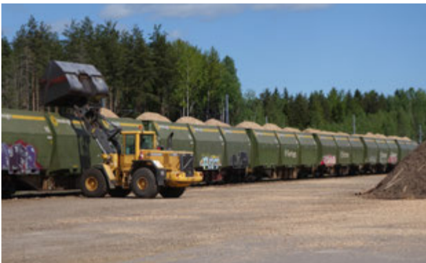
Erikoisrakenteinen juna, jolla voidaan kuljettaa haketta kustannustehokkaasti pitkiäkin matkoja.
