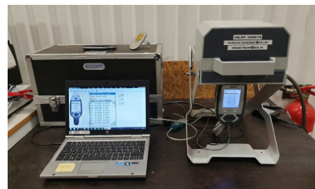
Kuva 2. XRF-spektrit näytteistä mitattiin 0,015 keV välein 0–50 keV alueella Niton XL3t (Thermo Scientific Niton, Billerica, MA, USA) ED-XRF-käsiyksiköllä, joka oli säteilyltä suojaavassa telineessä. Laitteessa on 50 kV röntgenputki Ag-kohtiolla ja Si(Pin)-detektorilla. Käytössä oli mittakuppi mylarkalvolla laitteen suunnassa.
