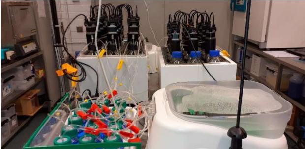
Kuva 3. Automatic Methane Potential Test System II (AMPTS II)-laitte. Valokuva: Viveka Öling-Wärnå.
