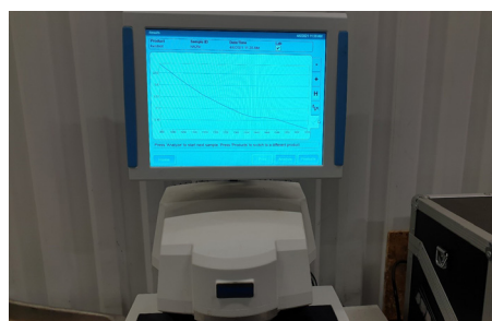
Figur 1. NIR-instrumentet som användes var Perten DA7250. Den är anpassad för kvalitetskontroller i t.ex. livsmedelsindustrin. Den mäter reflekterad strålning i den nära infraröda spektrat mellan 950 och 1650 nm.
