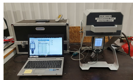
Figur 2. XRF-spectra från proverna mättes med 0.015 keV bins (intervaller) från 0 to 50 keV med en Niton XL3t (Thermo Scientific Niton, Billerica, MA, USA) ED-XRF handenhet som stod i ett ställ med skydd mot strålning. Instrumentet har en 50 kV röntgentub med ett Ag mål och en Si(Pin)-detektor. En mät kopp med mylarfilm mot instrumentet användes.
