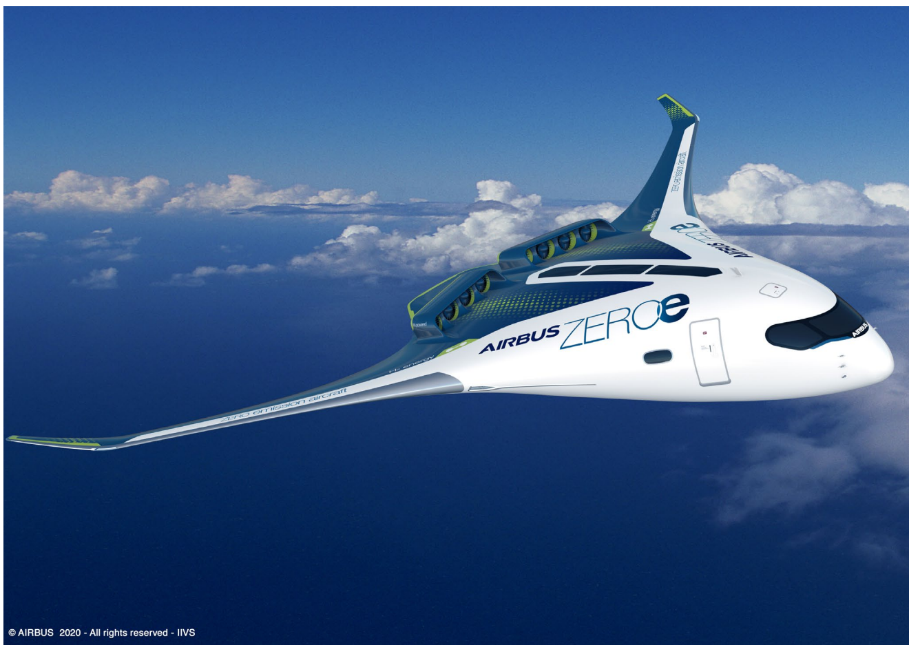
Figur 2: Airbus Zero-e Blended-Wing Body Concept. Den unika flygplansformen är till för att mer effektivt kunna lagra flytande väte ombord. Källa: Airbus.
