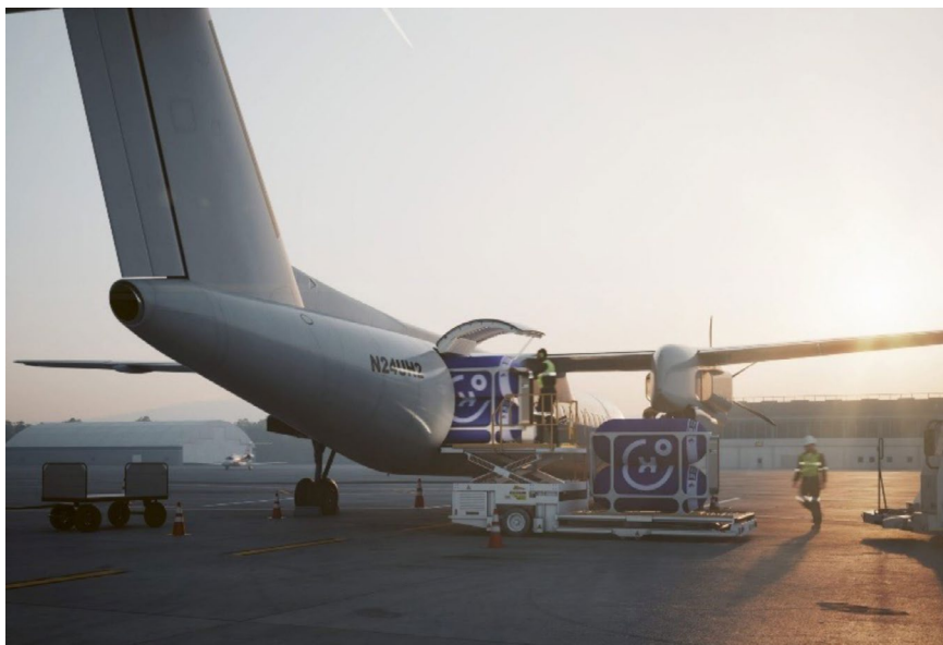
Figur 11: Hur Universal Hydrogen föreställer sig sitt modulära tankbytessystem. 54
